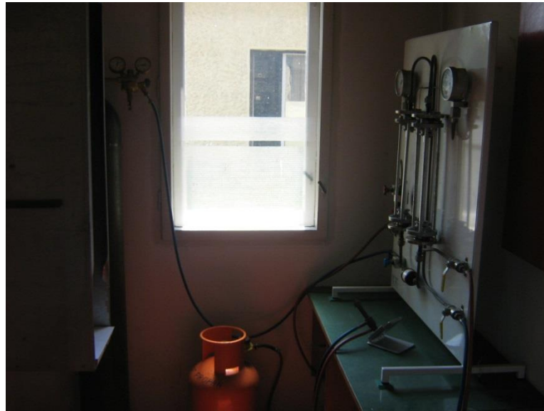
Слика бр. 8 Реализована инсталација за испитивање ширења пламена
