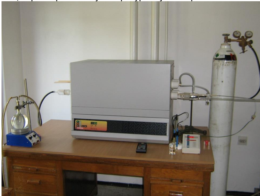
Слика бр. 14 Реализована изведба система за испитивање киселости ослобођених гасова при сагоревању материјала
