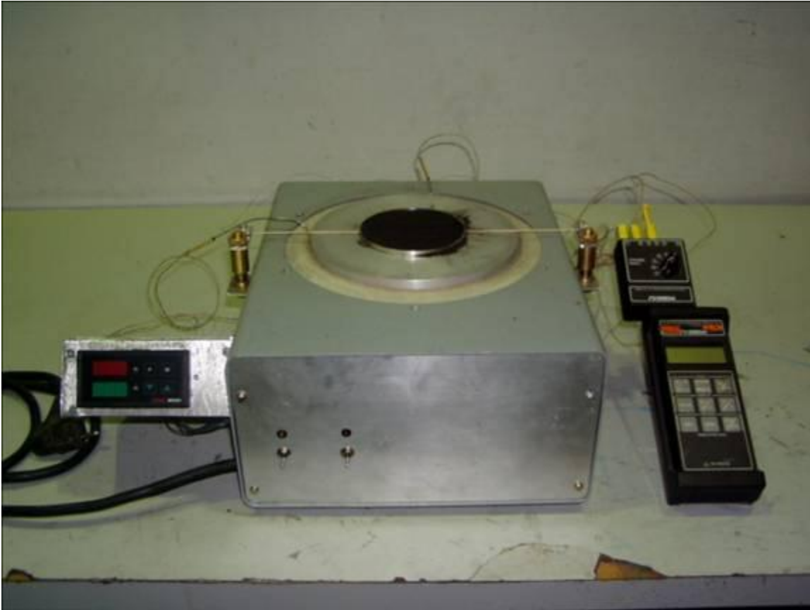
Slika 4 Aparatura za određivanje min. temperature sloja eksplozivne prašine
