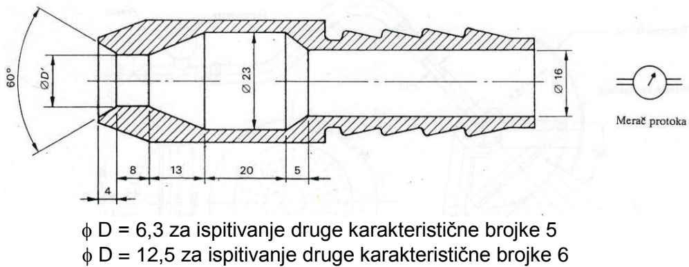
Slika 6 - Ispitni uređaj za proveru zaštite od vodenih mlazeva (mlaznica)
